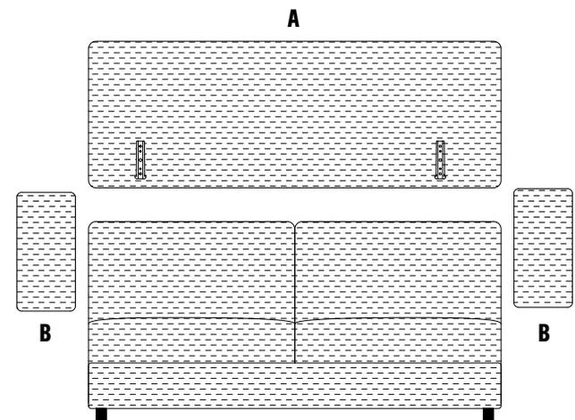
**A. Inserimento del pannello strutturale posteriore tramite doppia baionetta / Insertion of the backrest panel via double bayonet brackets.**
